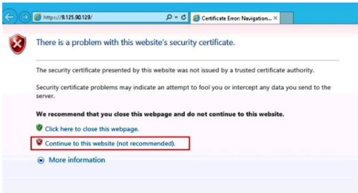
図 69. Lenovo Flex System シャーシ Web コンソールを開くときの認証エラー
